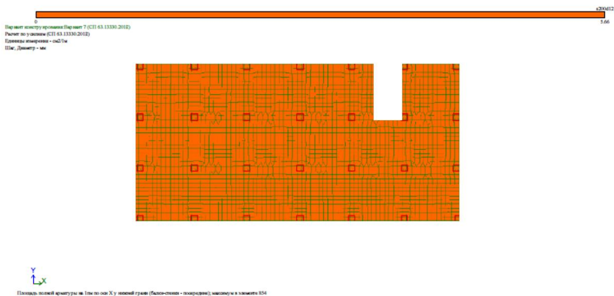
Рисунок 3.2.4 – Подбор нижней продольной арматуры плиты
