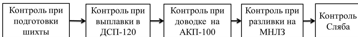
Рисунок 12 – Технологическая схема контроля при выплавке заготовки
