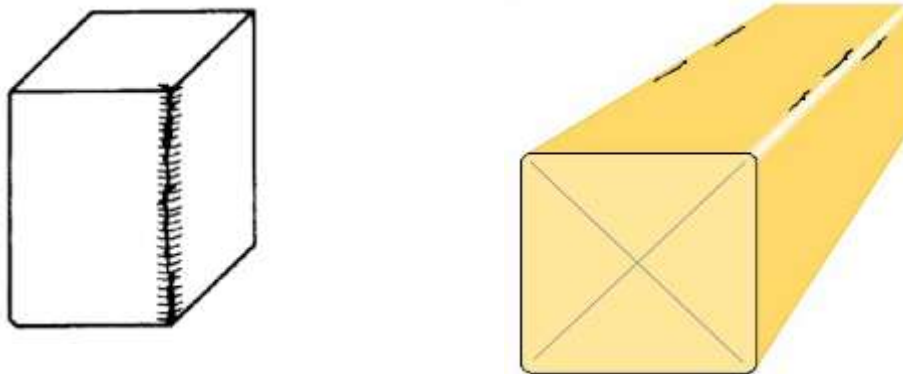
Рисунок 3.7 - Трещины продольные в угловом участке
