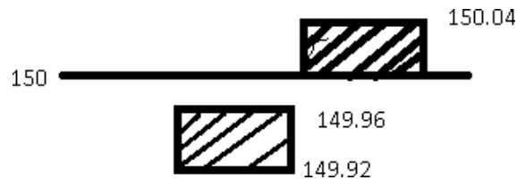
Рисунок 8 – Схема посадки шкива на вал электродвигателя
