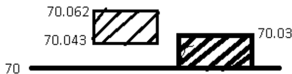
Рисунок 9 – Схема посадки подшипника на ступицу
