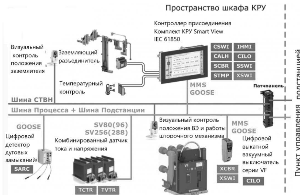
Рисунок 3 - Архитектура цифрового шкафа КРУ-10кВ серии «Волга»:
