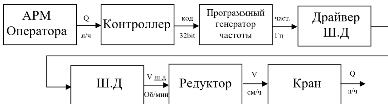
Рисунок 4.4 – Схема дозирования воды
