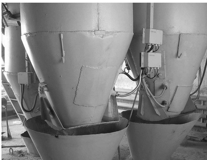
Рисунок 3.4 – Крепление П-образного датчика к бункеру
