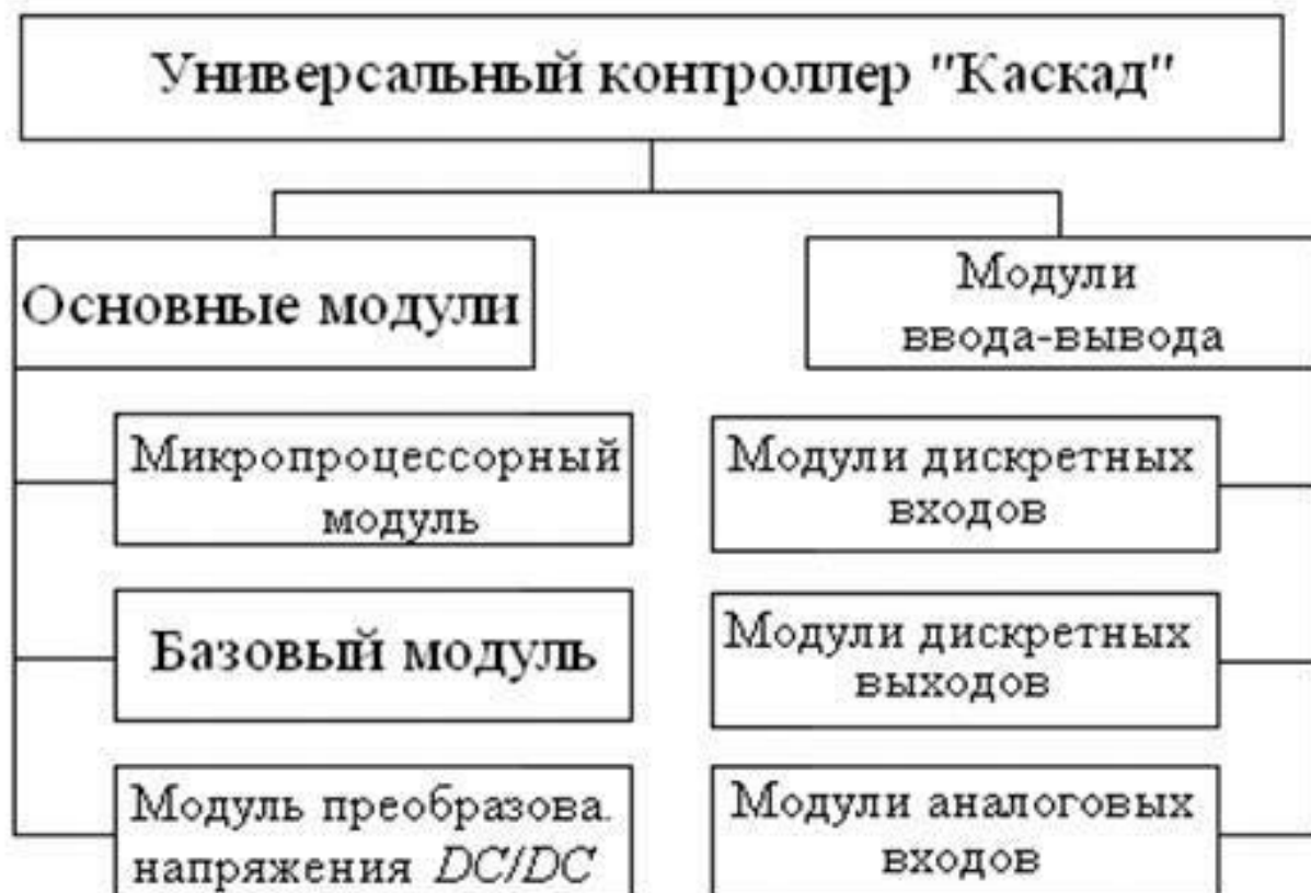
Рисунок 6.3 – Состав котроллера универсального
