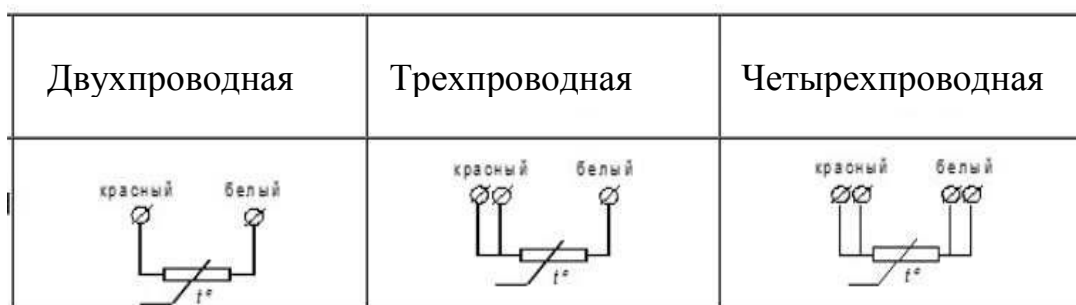
Рисунок 4.9 – схемы подключения термометров сопротивлений.
