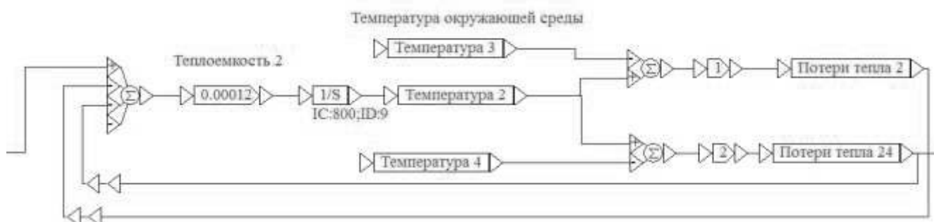
Рисунок 5.3 – Схема регулирования температуры в сварочной зоне верхнего подогрева
