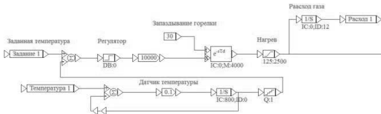
Рисунок 5.4 – Схема управление горелками
