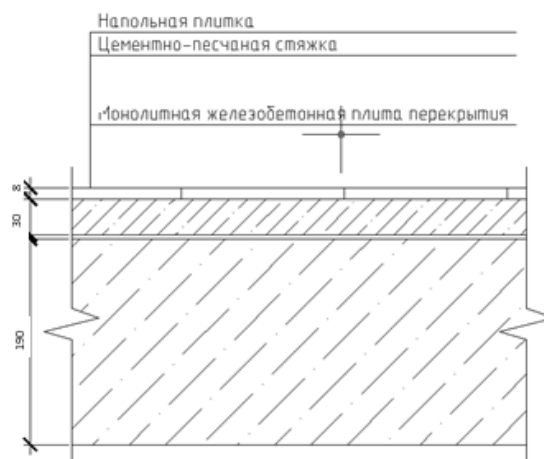
Рисунок 3.3 – Разрез перекрытия
