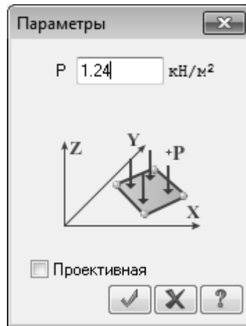
Рисунок 3.2 – Задание нагрузок от конструкции пола
