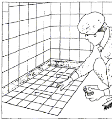
Рисунок 3.9 - Укладка плитки в ячейки шаблона
