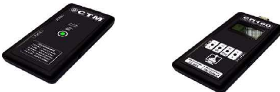
Рисунок 3.1 Считывателя регистратора параметров в комплекте с сервисным пультом ОНК-160
