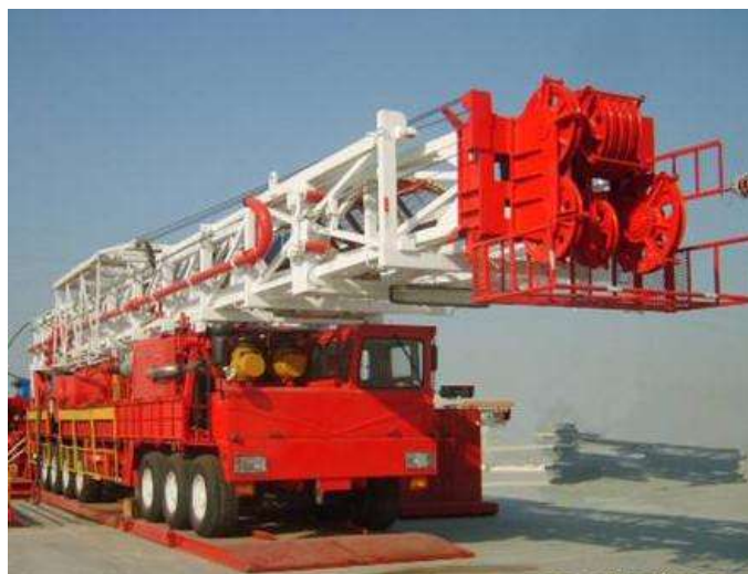
Рисунок 3.5 – Общий вид самоходного агрегата для ремонта скважин XJ 350
