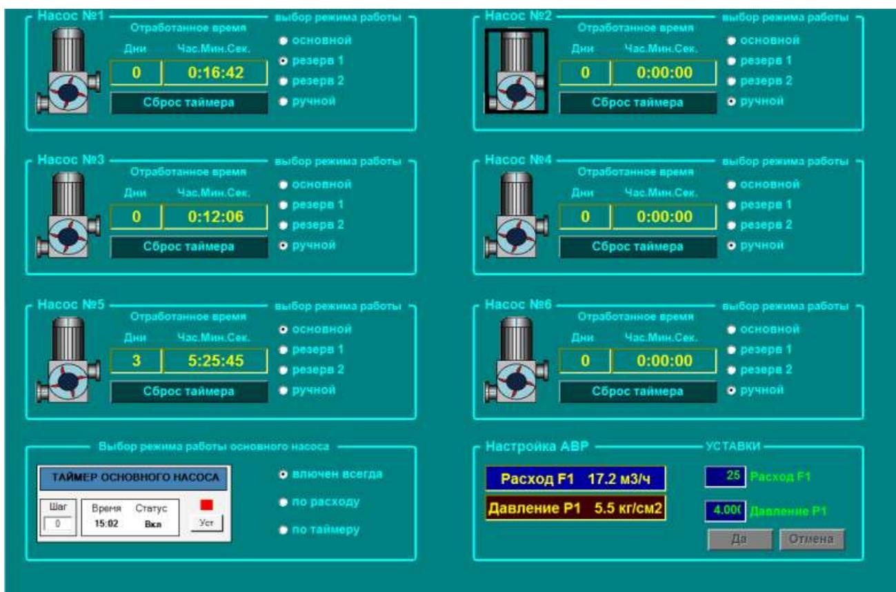
Рисунок 3.9 – Окно объекта АСУ водоснабжения
