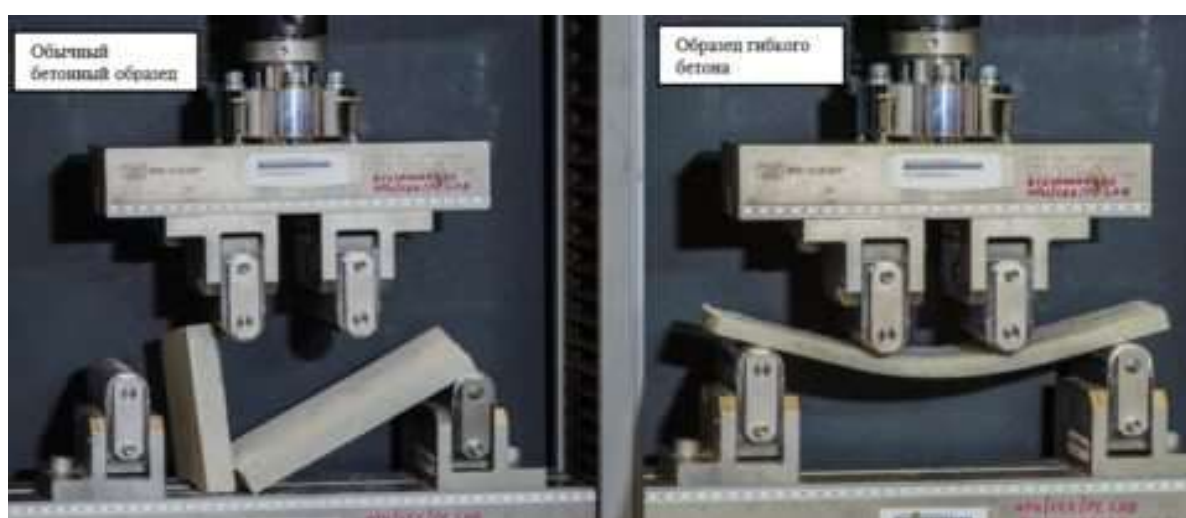
Рисунок 3.8 – Два образца обычного и «гнущегося» бетона под давлением изгибающей нагрузки одинаковой величины
