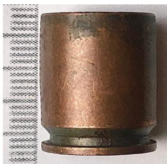
Иллюстрация 6. Корпус гильзы, стрелянной из огнестрельного оружия, изготовленного промышленным способом.
