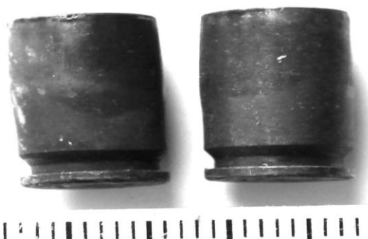
Иллюстрация 7. Корпус гильзы, стрелянной из огнестрельного оружия, изготовленного самодельным способом.
