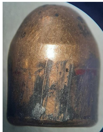
Иллюстрация 2. Следы канала ствола, промышленного изготовления, на поверхности пули.
