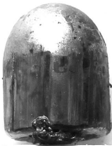
Иллюстрация 1. Следы канала самодельного ствола на поверхности пули.
