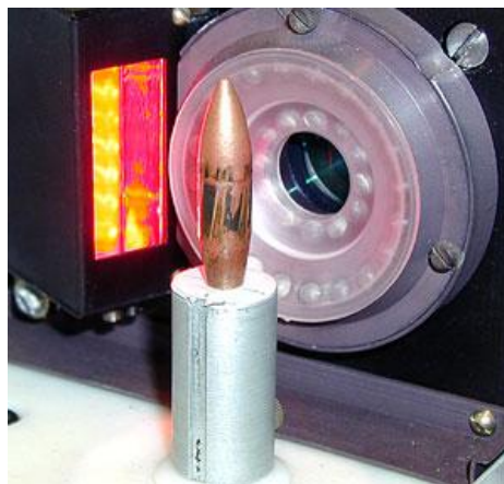
Рис. 13. Позиционирование пули для сканирования боковой поверхности
