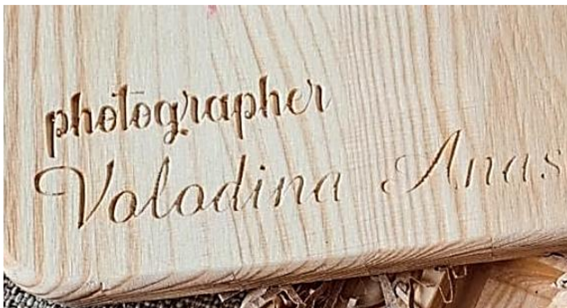
Фото 7. Маркировочное обозначение, нанесенное способом вырезания.
