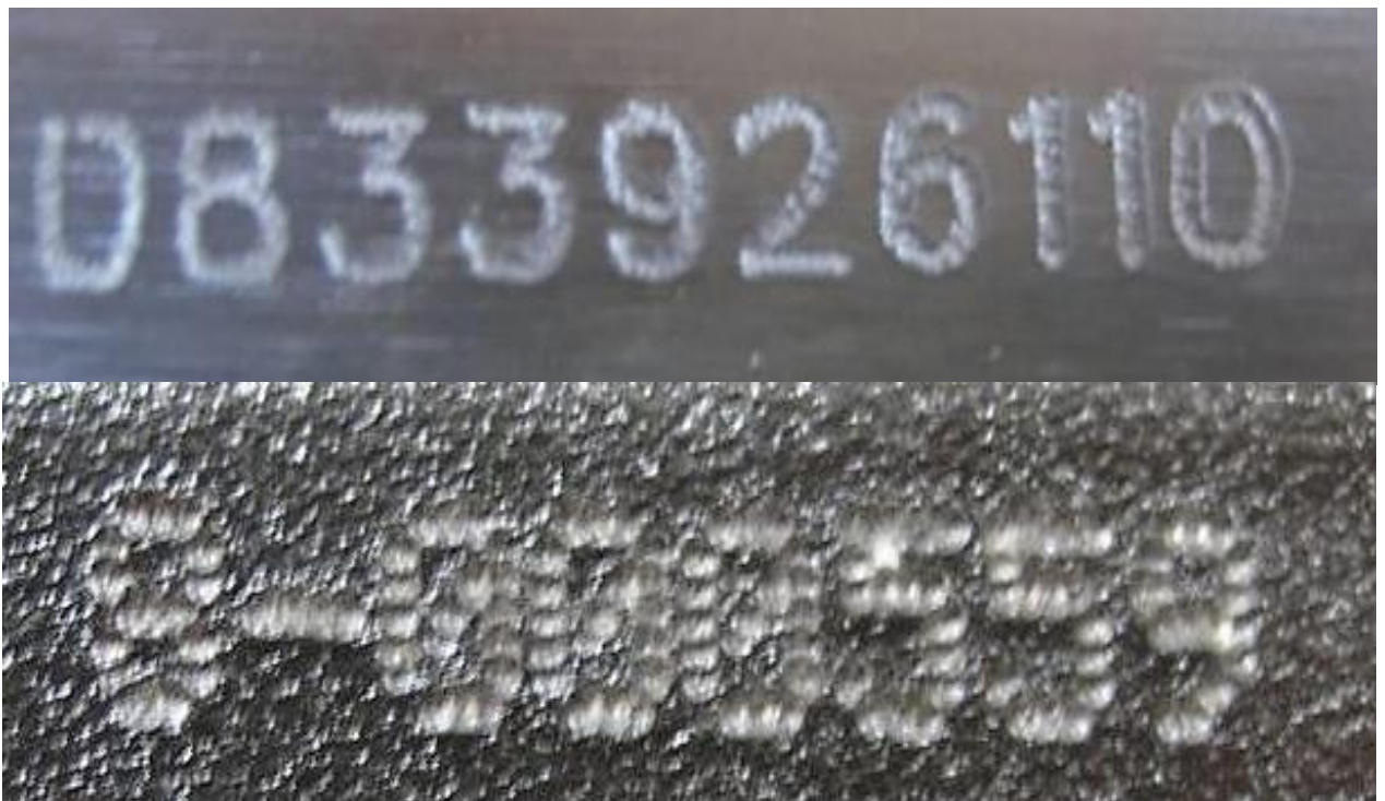
Фото 10.Маркировочные обозначения, нанесённые микроударным способом.
