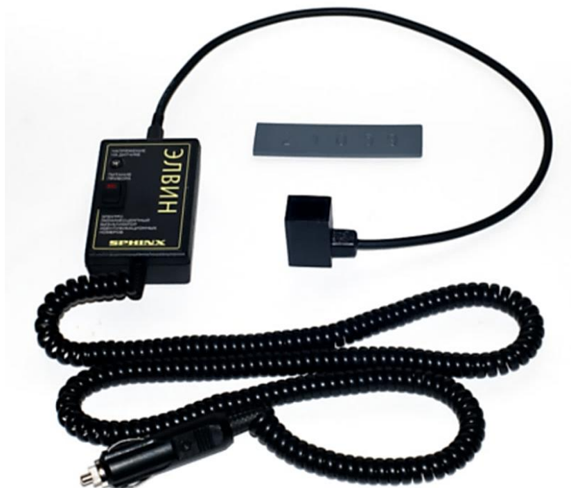
Фото 24. Электро - люминесцентный визуализатор идентификационных маркировочных номеров («ЭЛВИН»).
