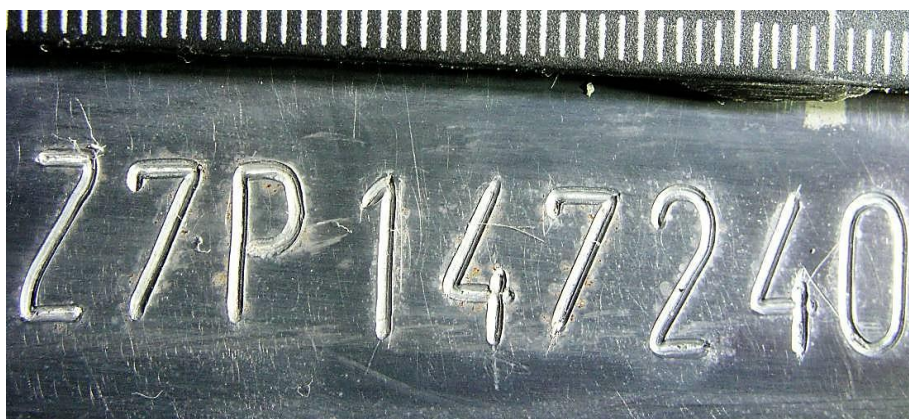
Фото 15. Восстановление маркировки на автомобиле Фольксваген Пассат после шлифования, полирования и травления поверхности.
