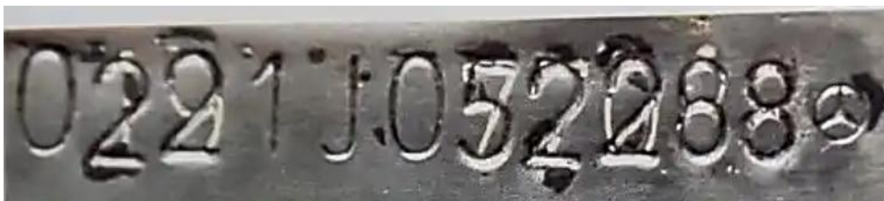
Фото 14. Восстановление измененного идентификационного номера химическим методом на автомобиле марки «Mercedes».
