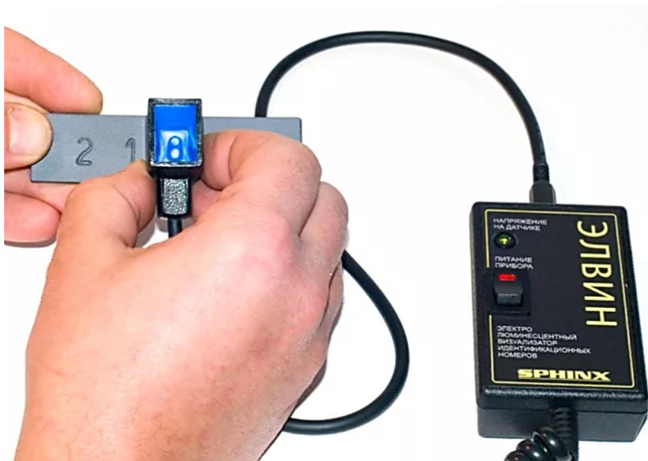
Фото 25. Применение «ЭЛВИН» при исследовании маркировочных обозначений.
