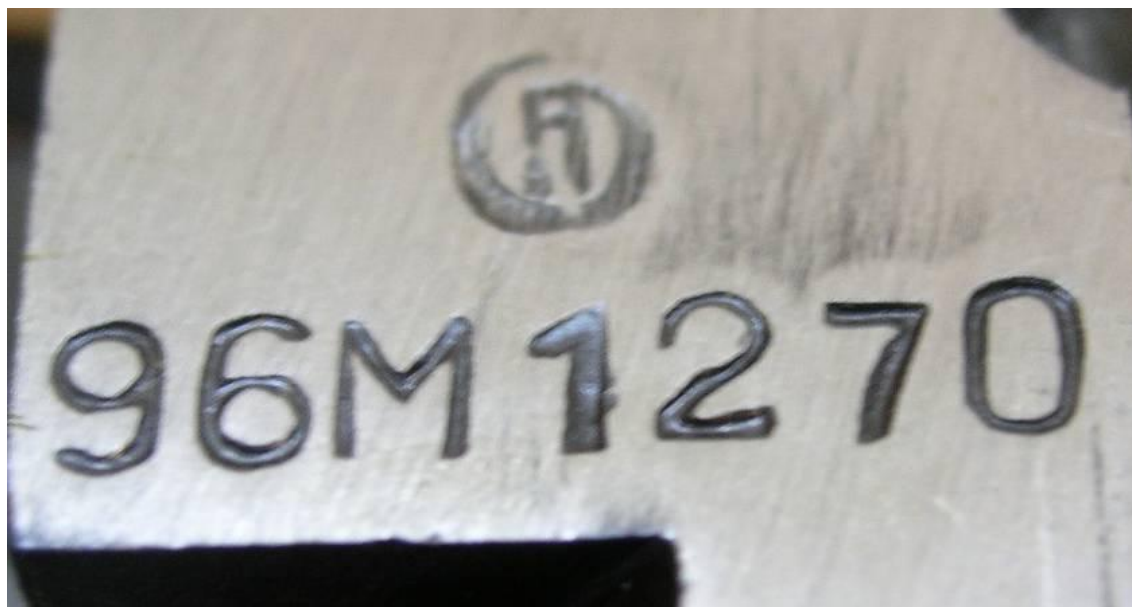
Фото9. Внешний вид маркировочного обозначения, нанесённого ручным ударным способом.
