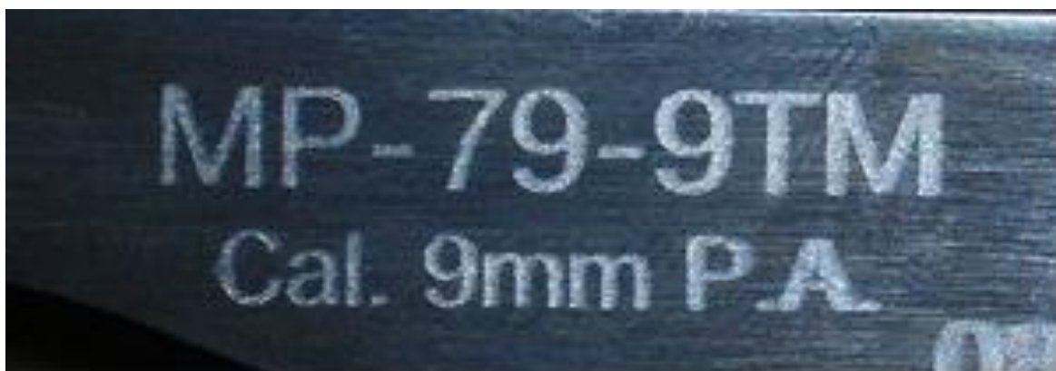
Фото 12. Маркировочные обозначения, нанесённые лазерным способом с малой глубиной проникновения.
