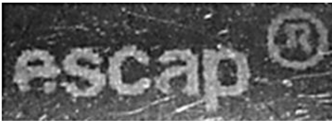
Фото 6. Маркировочное обозначение, нанесенное способом химического травления.
