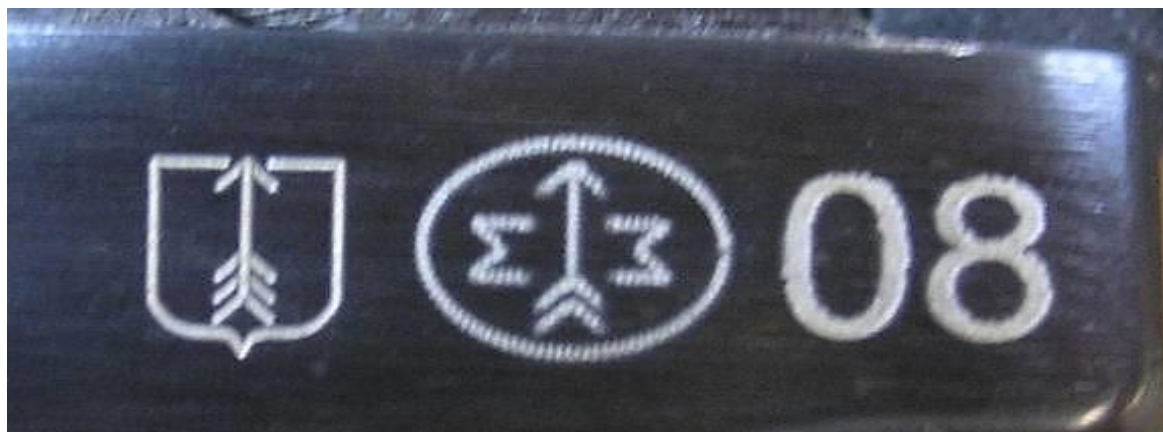
Фото 13. Маркировочные обозначения, нанесённые лазерным способом с большой глубиной проникновения.
