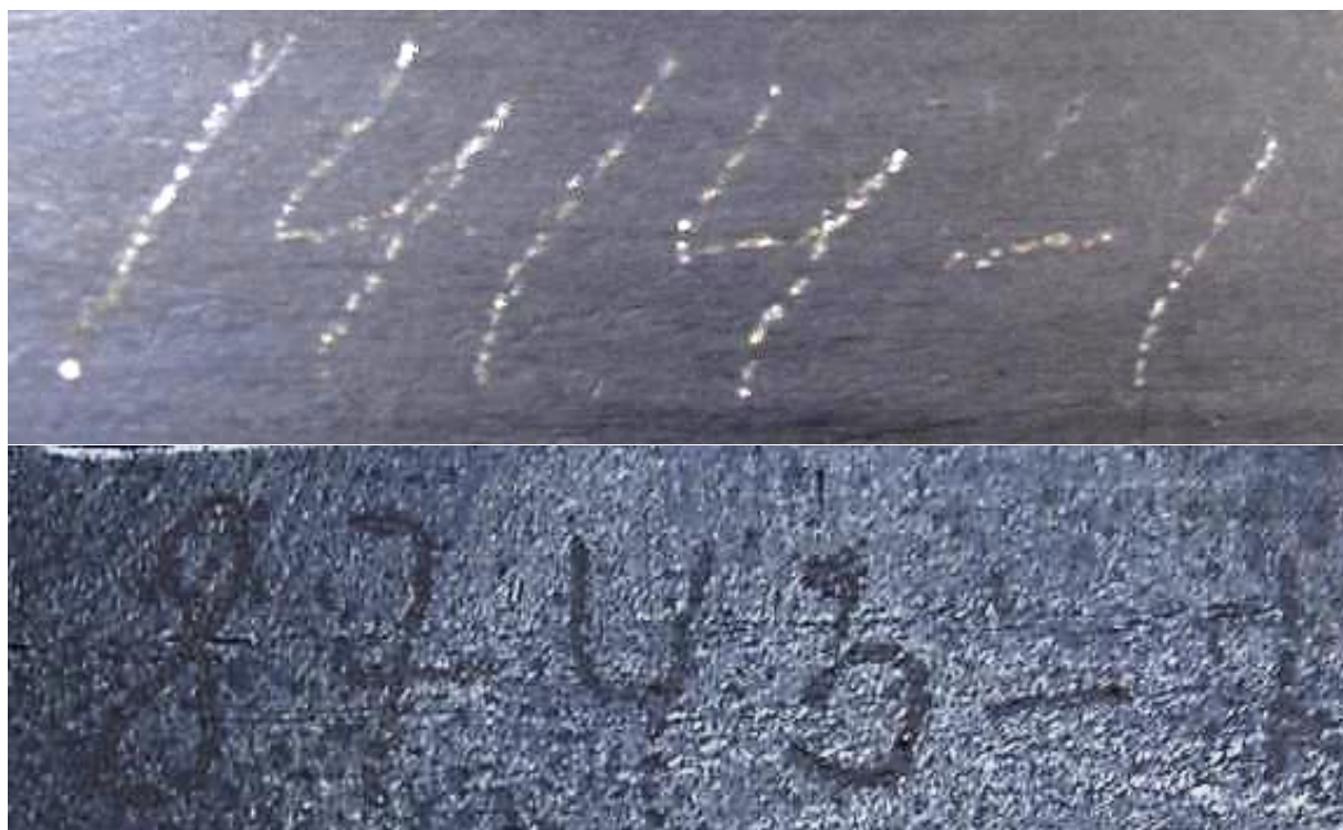
Фото 11. Маркировочные обозначения, нанесённые электроискровым способом.
