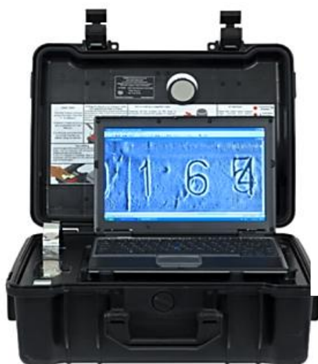
Фото 21. Магнитооптический прибор «Регула 7505М» для выявления маркировочных обозначений и возможности его применения.
