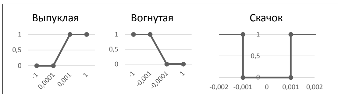
Рис. 7. Пример функций принадлежности для учета смены тренда показателя Fig. 7. Example of accessory functions for accounting for trend change of key figure
