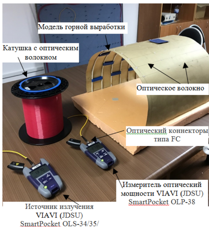
Рис. 1. Внешний вид лабораторного стенда для практической апробации теоретических результатов исследования Fig. 1. Appearance of laboratory stand for practical testing of theoretical results of research
