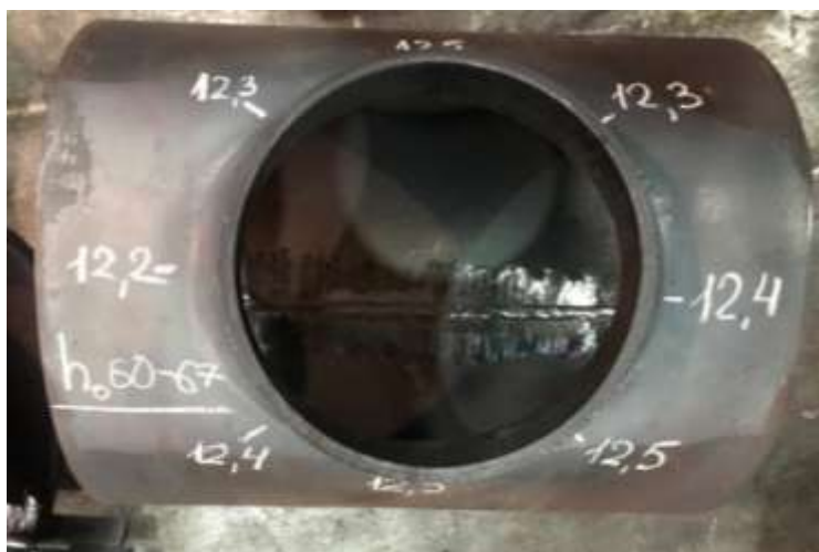
Рис. 13. Отштампованный тройник 530x325 18x12
