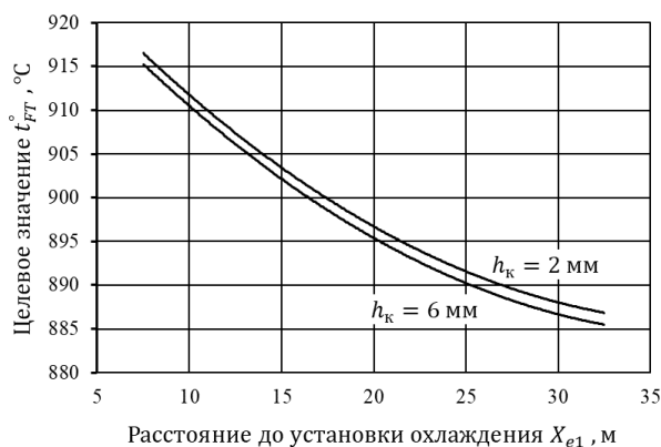
Рис. 5. Требуемая температура конца прокатки в зависимости от расстояния между последней чистой клетью и установкой ускоренного охлаждения
