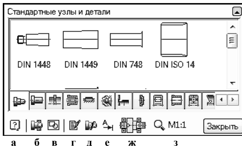
Рис. 6. Кнопки диалогового окна «Стандартные узлы и детали»: а – помощь; б – добавить элемент; в – вставить группу; г – редактировать объект; д – вставить расчет; е – добавить вид/разрез; ж – разрез; з – масштаб
