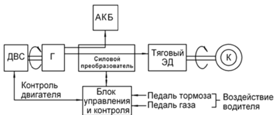
Рис. 3. Основные компоненты комбинированной энергетической установки
