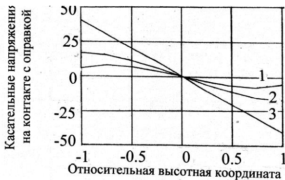
Рис. 5. Характер изменения касательных напряжений на контакте с оправкой ( h/R_0=0,3 ; r_0/R_0=0,5 )
