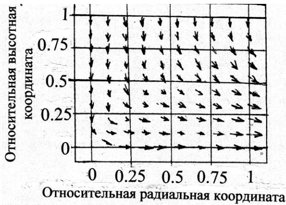
Рис. 4. Векторное поле скоростей перемещения материальных частиц при осадке сплошного цилиндра в условиях прилипания на контакте с инструментом ( h/R = 0,5 )
