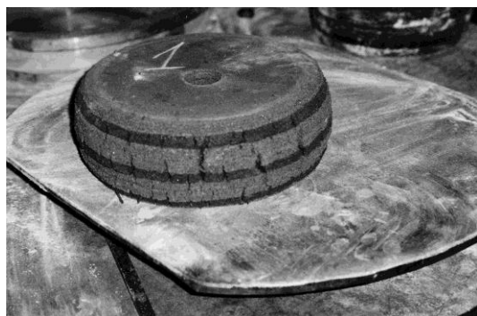
Рис. 22. Образец, осаженный между сухими металлическими плитами с относительной деформацией \delta = 15\%
