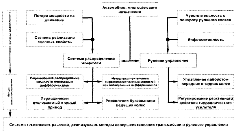
Рисунок 2 – Методология модернизации АМН
