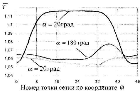
Рис. 14. Распределение температуры в слое по угловой координате \varphi
