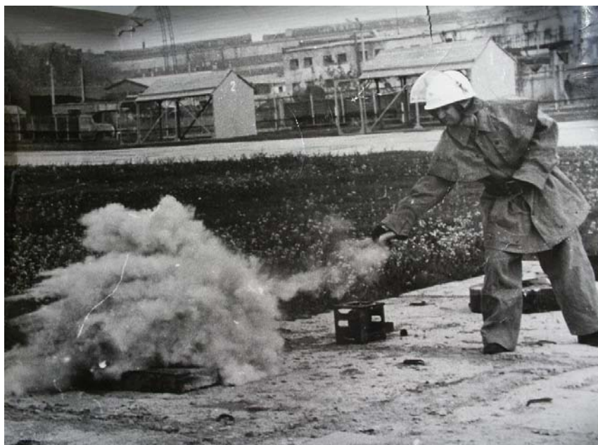
Рис. 4. Работа огнетушителя «Миг-1»
