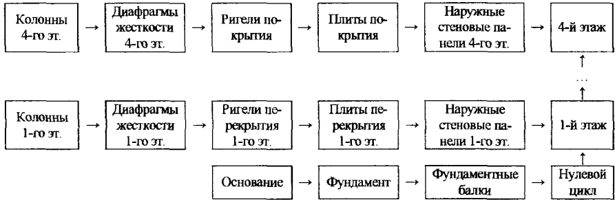
Рис. 1. Дерево несущих конструкций здания АБК
