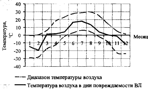
Рис. 3. Соотношение среднесуточной амплитуды температуры воздуха в районе обслуживания электрических сетей и средней температуры воздуха в дни возникновения нарушений в работе электрических сетей
