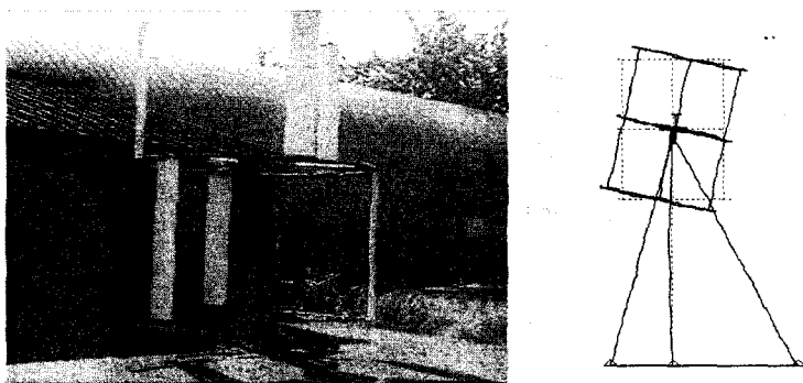
Рис. 16. Исследование испытуемой установки на предмет определения вибросмещений ротора и проведения весовой балансировки в предэксплуатационный период с целью снижения вибраций
