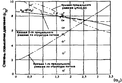
Рис. 8. Рабочая характеристика, экспериментальные точки, кривые ограничений по коэффициенту скольжения и структуре потока ( \Gamma = 35 , \Omega_3 = 0,3 , \Omega_{s4} = 16 )
