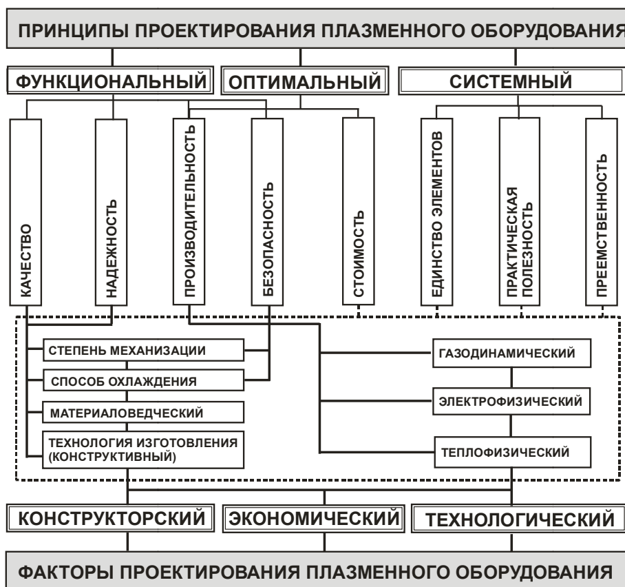
Рис. 1. Принципы и факторы проектирования плазменного оборудования
