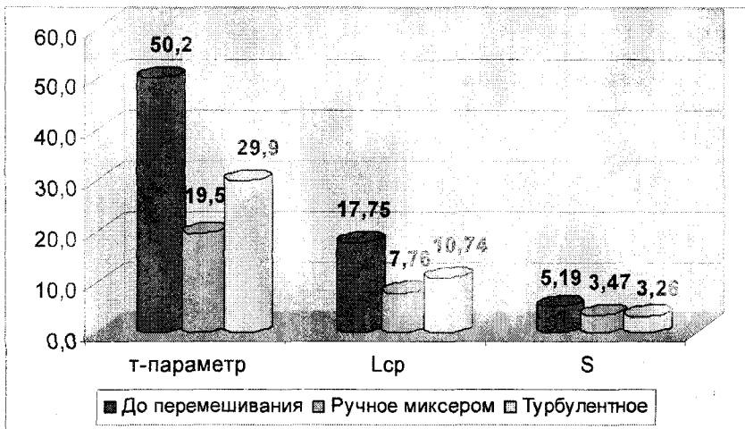
Рисунок 3. Значения t -параметра, средней длины ( L_{cp} ) и среднего квадратического отклонения ( S ) для фибр, подвергшихся различным технологическим воздействиям при перемешивании.
