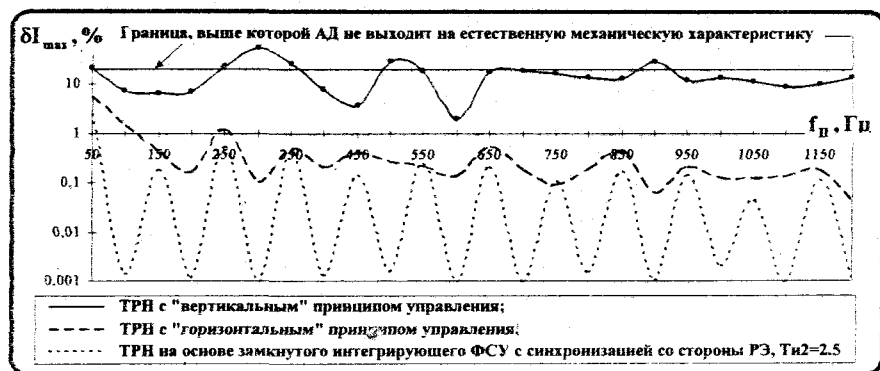
Рис. 9. Максимальная относительная ошибка тока статора АД \delta I_{max} под действием сигнала помехи для ТРН по схеме «тиристор-тиристор» с различными классами фазосдвигающих устройств (ограничение пускового тока 2,5 от номинального значения)
