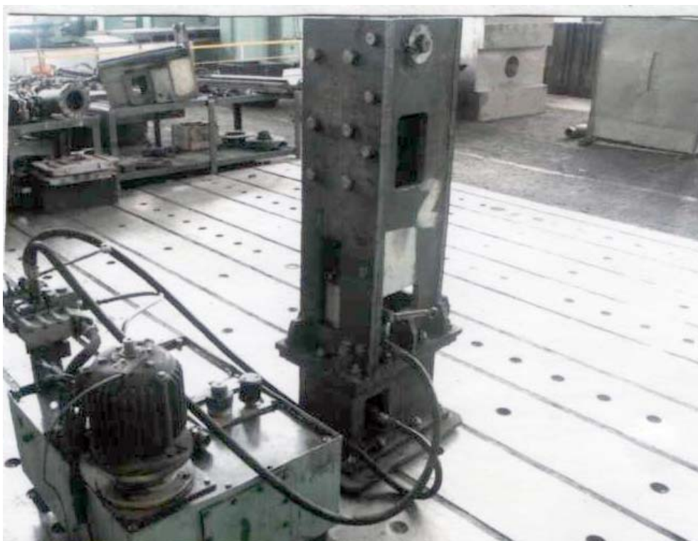
Рис. 9. Общий вид установки с гидростанцией
