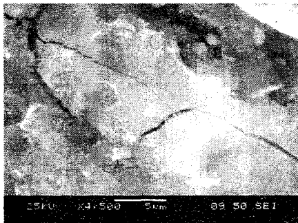
Рис. 5 Трещина, образовавшаяся вследствие гидратации пережога MgO в магнезиальном камне (Микрокремнезем = 7,5 %, Тальк = 5 %, плотность затворителя – 1,24 г/см 3 ) при увеличении \times 4500
