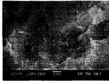
Рис. 11 Фотография скола модифицированного магниального камня ( \text{NaCl} = 5\% , \text{KCl} = 5\% , плотность затворителя 1,24 \text{ г/см}^3 ) при увеличении \times 10000
