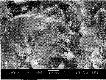
Рис. 10 Фотография скола модифицированного магниального камня ( \text{NaCl} = 5\% , \text{KCl} = 5\% , плотность затворителя 1,24 \text{ г/см}^3 ) при увеличении \times 1300
