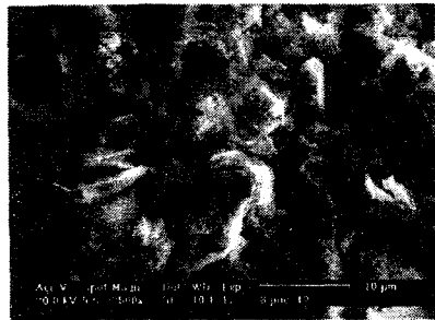
Рис. 3 Фотография скола магниезального камня (Микрокремнезем = 7,5 %, Тальк = 5 %, плотность затворителя – 1,24 \text{г}/\text{см}^3 ) при увеличении \times 2500
