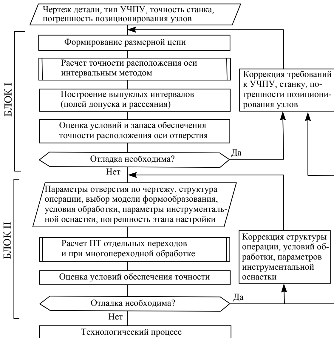
Рис. 2. Структура методики обеспечения точности при обработке отверстий КМИ на станках с ЧПУ
