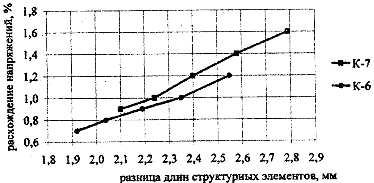
Рис. 3. График зависимости расхождения напряжений в структурных элементах стальных канатов К-7 и К-6 от разницы длин этих элементов
