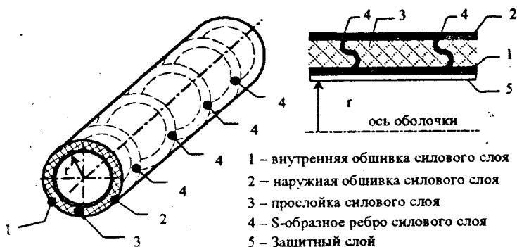
Рис. 8. Слоистая оболочка и ее продольный разрез
