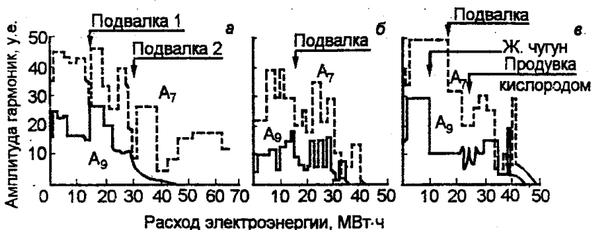
Рис.5. Амплитуда седьмой (А7) и девятой (А9) гармоник при расплавлении углеродистой легковесной шихты (а), тяжеловесной шихты коррозионностойких марок стали (б) и углеродистой шихты при использовании жидкого чугуна (в)
