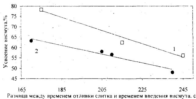
Рис. 4. Влияние разницы между временем отливки слитка и временем введения висмута в сталь, и высоты налива стали в изложницу до дачи висмута на усвоение висмута: 1 — высота налива 300—400 мм; 2 — высота налива 100—250 мм
