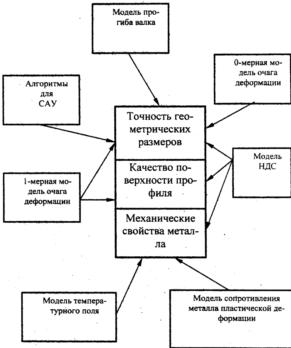
Рис. 4. Схема связи математических моделей и характеристик качества проката
