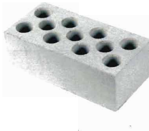
Рис.20 – кладка стен Рис. 21 – силикатный кирпич.
