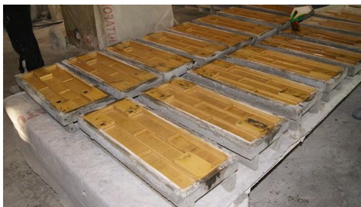
Рисунок 12 - форма для изготовления панели с имитацией кладки
