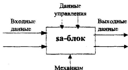
Рис. 1.  $sa$ -блок функциональной SADT-модели
