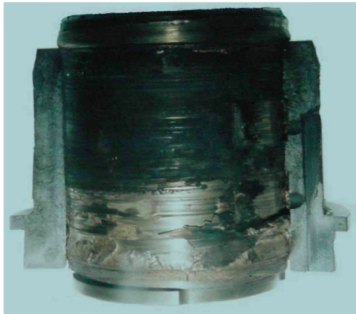
Рис. 1. Внешний вид втулки и вкладыша пускового подшипника
