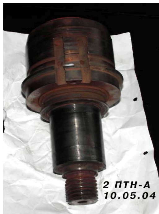
Рис. 5. Вал с приваренной втулкой подшипника
