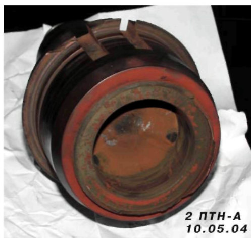
Рис. 4. Поверхность долома вала питательного насоса
