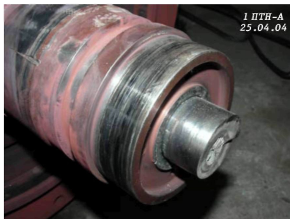
Рис. 3. Разрушенный участок вала
