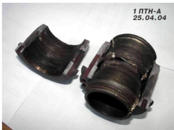
Рис. 2. Разрушенный вкладыш пускового подшипника
