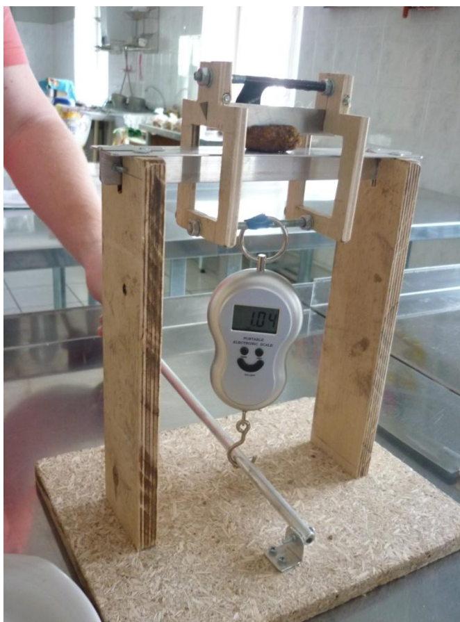
Рисунок 2.3 – Установка для определения показателя усилие среза
