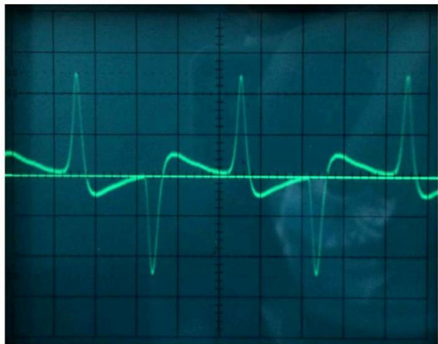
Рисунок 9. АИМ. Частота несущего ВЧ сигнала 450 МГц
