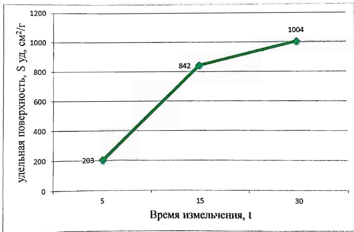
Рисунок 3.2 – Зависимость удельной поверхности материала от времени измельчения
