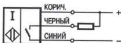
Рисунок 2.2 – Индуктивный датчик ISN EC85P-312P-35G-LZS4 фирмы ТЕКО и его подключение
